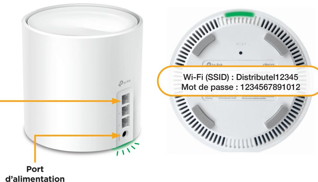
⚠ Si le voyant est **rouge**, réinitialisez le modem et le boîtier sans fil en débranchant les adaptateurs d'alimentation.
